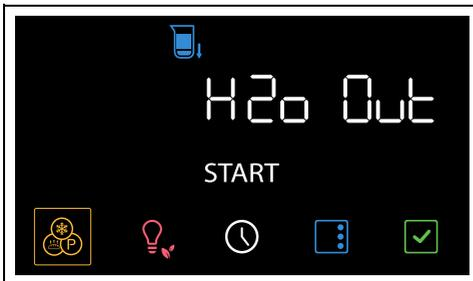
4. Zur Bestätigung die Taste
