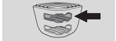
10. Darauf achten, dass die 4 Stifte der Innenverglasung in den Aufnahmen der Klappe stecken.
