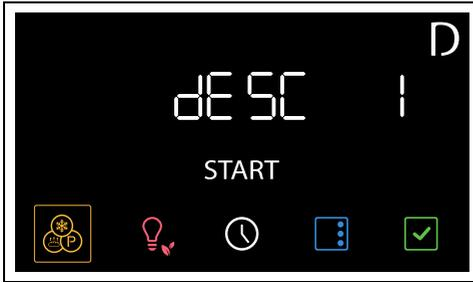
Es wird empfohlen, die Entkalkung bei jeder Anzeige im Display vorzunehmen, um den Kessel in bestem Betriebszustand zu erhalten.
