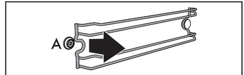
3. Den Rahmen vom hinteren Stiff B herausziehen, der sich unten an der Seitenwand befindet.
