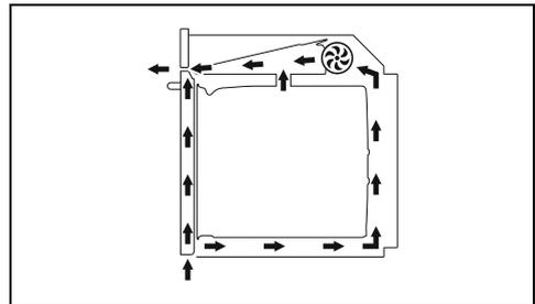
Der Lüfter kühlt das Gerät ab und setzt sich während des Garvorgangs in Betrieb.
