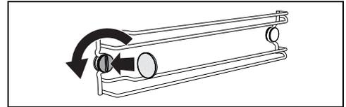
2. Den Rahmen vorsichtig zum Inneren des Garraums ziehen, so dass er sich aus der Einrastvorrichtung A löst.
