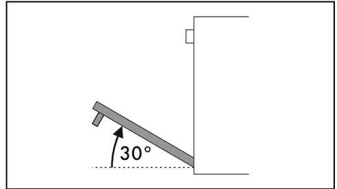
3. Zum Wiedereinsetzen der Tür müssen die Scharniere in die dafür vorgesehenen Schlitzte am Backofen eingefügt werden, wobei sichergestellt werden muss, dass die Ausparungen **A** fest auf den Schlitzten aufliegen.
