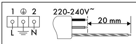
Dreipoliges Kabel 3 x 1,5 mm<sup>2</sup>.
