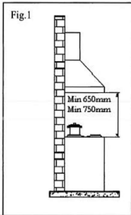
Die Haube wird mit allem für die Installation notwendigen Zubehör geliefert. **Die Mindestentfernung zwischen dem unteren Rand der Haube und dem Kochfeld muss mindestens 750 mm bei Gasbetrieb und 650 mm bei elektrischen Kochherden betragen** (Abb. 1). **Falls der Motoreingang mit einem Rückschlagventil für die Rauchgase versehen ist, sicherstellen, dass es sich ganz frei öffnen und schließen kann.**
